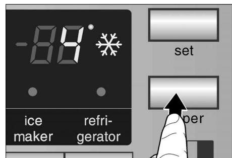
При каждом нажатии клавиши режим включается или выключается. При включенном режиме суперохлаждения на дисплее горит соответствующий символ.
