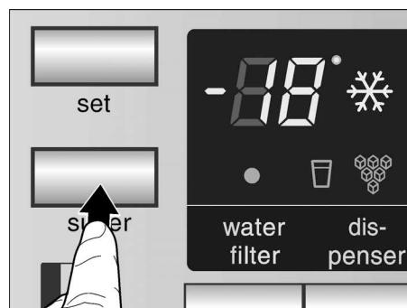
При каждом нажатии клавиши режим включается или выключается. При включенном режиме суперзамораживания на дисплее горит соответствующий символ.
