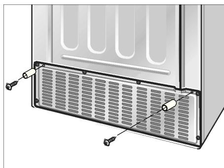
Это позволит выдержать минимальное расстояние до стены 30 мм и обеспечит вентиляцию.
