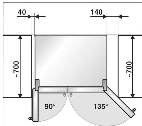
Если прибор устанавливается под полкой или шкафом, необходимо оставить небольшой зазор, чтобы при необходимости прибор можно было извлечь из ниши.
